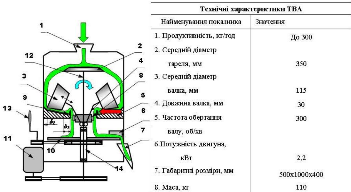
Рис. 2. Схема ТВА без рихлення та його технічні характеристики 1 – лійка живлення; 2 – розподілювач; 3 – валок; 4 – важіль; 5 – таріль; 6 – скидач; 7 – лоток розвантаження; 8 – упори; 9 – кільце регулювання товщини шару; 10 – розвантажувальний таріль; 11 – основний привод; 12 – приводний вал; 13 – привод розвантаження; 14 – підшипниковий стакан.
