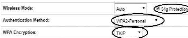
Рис. 2. Встановлення протоколу передачі даних та алгоритм шифрування у маршрутизаторі RT-N13U
