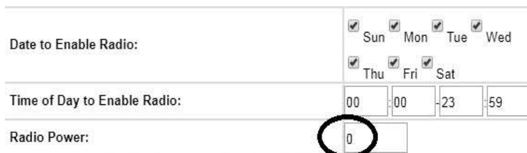
Рис. 5. Налаштування потужності передавача у маршрутизаторі RT-N13U
