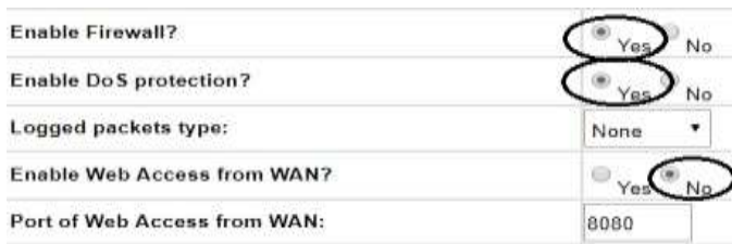
Рис. 3. Налаштування файрвола у маршрутизаторі RT-N13U
