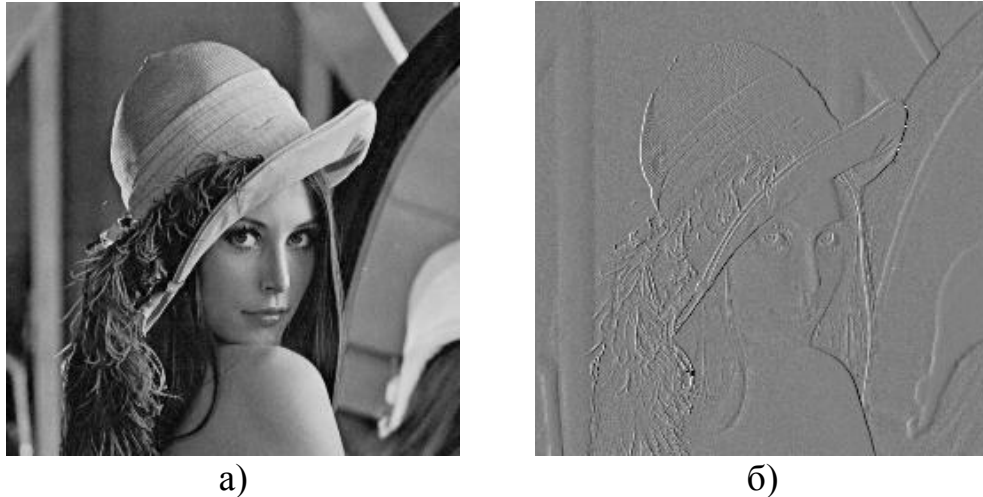
Рис. 1.4. Відхилення яскравостей суміжних пікселів зеленої компоненти зображення Lena.bmp до застосування предиктора (а) та після застосування Left -предиктора (б)
