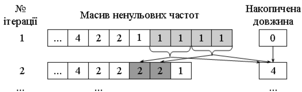
Рис. 2.4. Приклад окремого опрацювання малих частот в процесі точного розрахунку довжини блоку кодів HUFF
