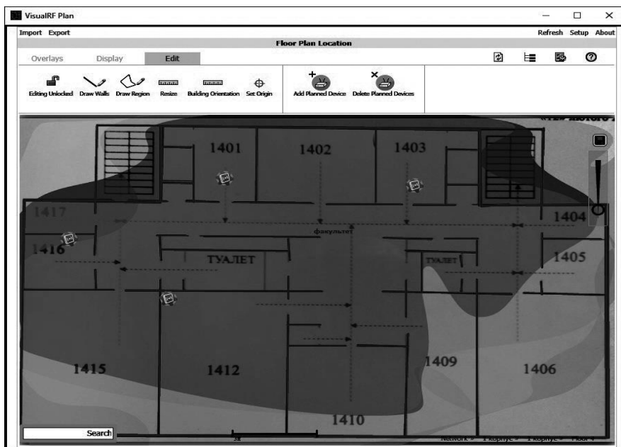
Рис. 4. Моделювання у системі VisualRF Plan стану інтенсивності сигналу Wi-Fi мережі четвертого поверху першого корпусу Міжнародного економіко-гуманітарного університету імені академіка Степана Дем'янука, при наявності чотирьох точок доступу
