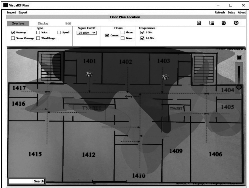
Рис. 3. Моделювання у системі VisualRF Plan поточного стану інтенсивності сигналу Wi-Fi мережі четвертого поверху першого корпусу Міжнародного економіко-гуманітарного університету імені академіка Степана Дем'янчука
